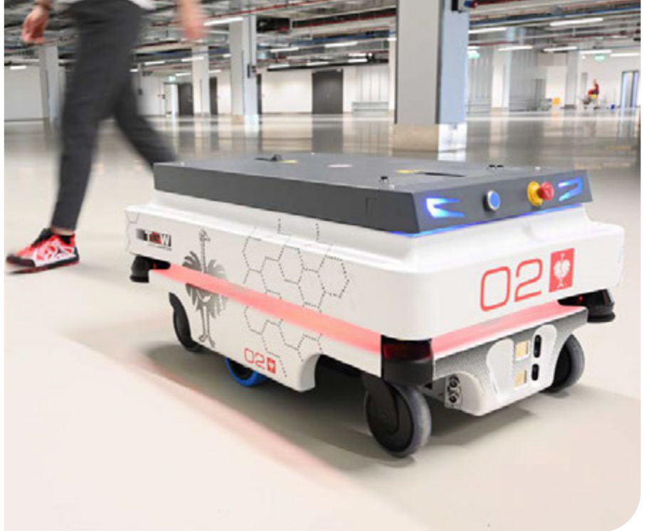
Quba. Die mobilen Roboter transportieren unterschiedliche Ladungsträger wie Paletten, Kartons oder Behälter
